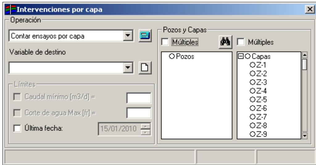
Los valores obtenidos con esta ventana se guardan como datos de pozo-capa, lo que permite visualizarlos rápidamente como burbujas o en un reporte. En el caso de la interpretación del resultado de los ensayos, el mismo es guardado como un atributo dinámico del pozo en la correspondiente capa, y se puede ver fácilmente en la ventana **Mapa**, como símbolo en el pozo.
